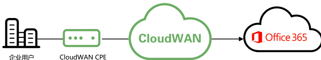
图 1： AppEx CloudWAN Office365 访问加速方案拓扑图
